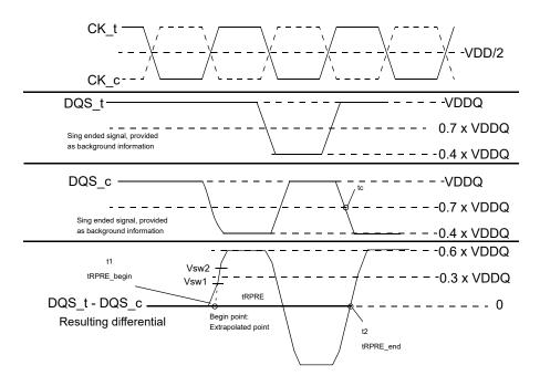
NOTE 1 Low Level of DQS\_t and DQS\_c =  $VDDQ/(50+34) \times 34$ =  $VDDQ \times 0.40$
