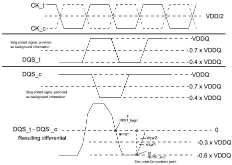
NOTE 1 Low Level of DQS\_T and DQS\_c = VDDQ/(50+34) x 34 = VDDQ x 0.40
