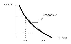
dTDQSCKdV = I tDQSCK(VDD,max) - tDQSCK(VDD,min)I / IVDD,max - VDD,minI
